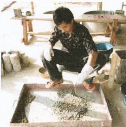
3. เติมน้ำหลังจากผสมดินกับซีเมนต์ให้เข้ากันแล้ว
