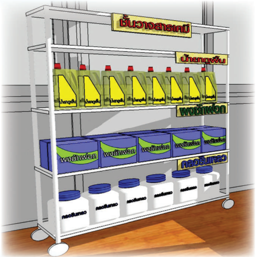
รูปที่ 22 เก็บแยกสารเคมีเป็นหมวดหมู่ และมีฉลากชัดเจน
