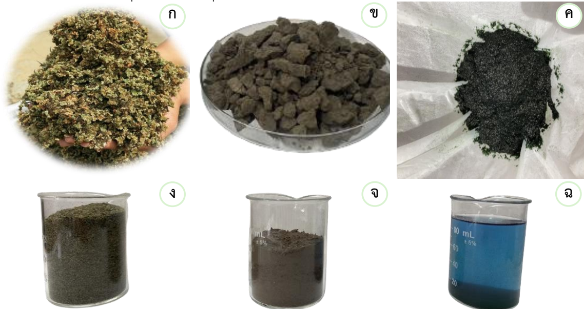
ภาพที่ 10 วัตถุดิบที่ใช้เป็นส่วนผสมของผลิตภัณฑ์ชีวภาพอัดเม็ด และการเตรียมวัสดุก่อนอัดเม็ด ก) แहनแดงแห้ง ข) ดินเหนียว ค) เซลล์สดสาหร่ายสีเขียวแกมน้ำเงิน ง) แहनแดงแห้งบด จ) ดินเหนียวบด ฉ) สารสกัดสาหร่ายสีเขียวแกมน้ำเงินเข้มข้นที่เจือจางด้วยน้ำอัตราส่วน 1:9
