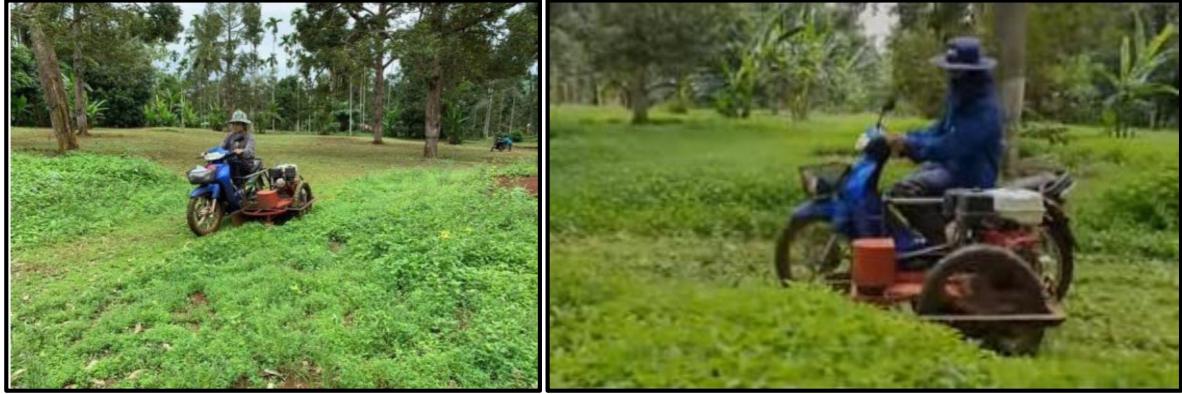
เครื่องตัดหญ้านำมาติดกับมอเตอร์ไซค์แบบรถพ่วงเพื่อลดต้นทุนแรงงานการตัดหญ้า
