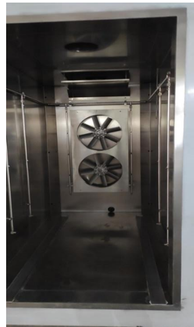
โครงสร้างภายในเครื่องทำความเย็นยิ่งยวด มีระบบพ่นไนโตรเจนเหลวบริเวณด้านข้าง และใช้พัดลมช่วยในการไหลเวียน (flow) ของก๊าซไนโตรเจน
