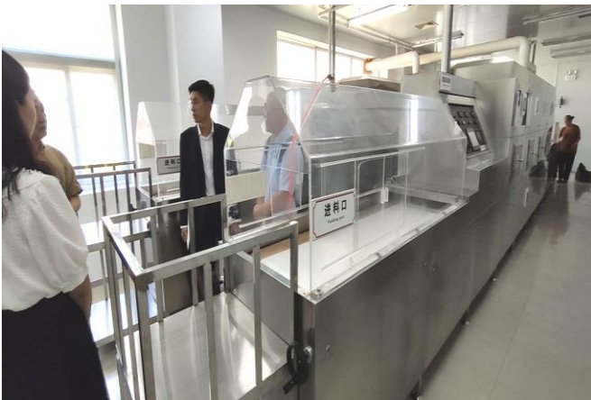
เครื่องฆ่าเชื้อรังนกติดขนโดยใช้วิธี Heat Treatment ด้วยเทคโนโลยี Microwave Sterilizer
