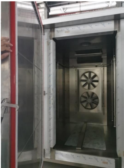
โครงสร้างภายในเครื่องทำความเย็นยิ่งยวด มีระบบพ่นไนโตรเจนเหลวบริเวณด้านข้าง และใช้พัดลมช่วยในการไหลเวียน (flow) ของก๊าซไนโตรเจน
