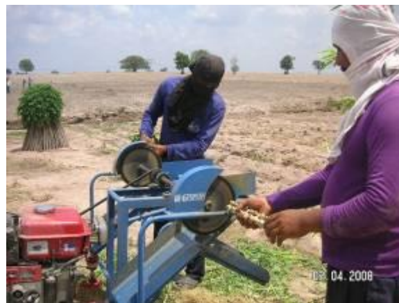
การตัดท่อนพันธุ์ด้วยเครื่องจักร
