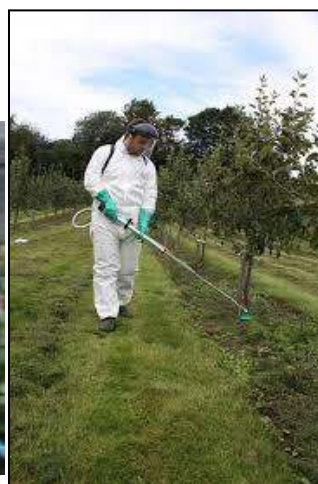
ภาพที่ 15 เครื่องพ่นสารแบบจานหมุน ชนิดใช้ควบคุมแมลง (ซ้าย) และชนิดใช้ควบคุมวัชพืช (ขวา)
