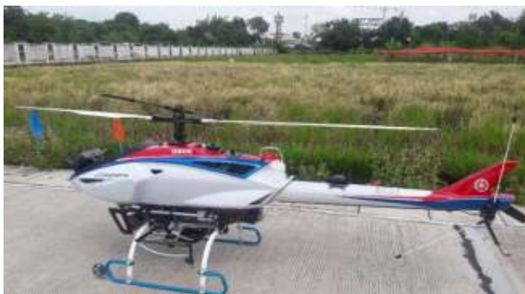
ภาพที่ 17 เฮลิคอปเตอร์แบบไร้คนขับ ของบริษัท ไทยยามาฮ่ามอเตอร์ จำกัด
