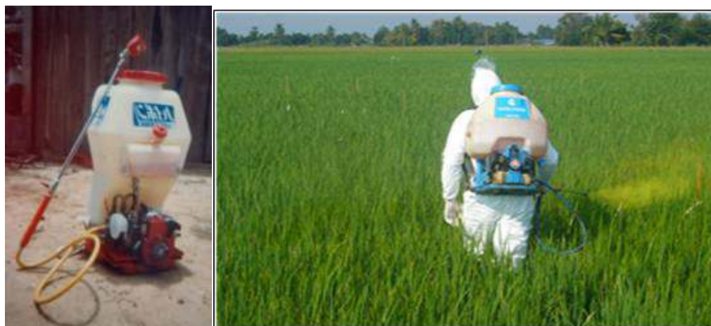
ภาพที่ 11 เครื่องยนต์พ่นสารสะพายหลังแบบใช้แรงดันน้ำ
