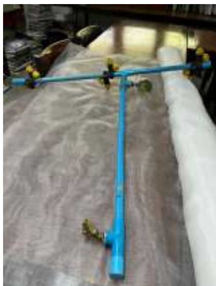
ภาพที่ 2 การพ่นสารด้วยเครื่องยนต์พ่นสารสะพายหลังแบบแรงดันน้ำสูง ประกอบก้านฉีดแบบคานคู่แนวตั้ง 2 ด้าน ใช้หัวฉีดแบบพัด
