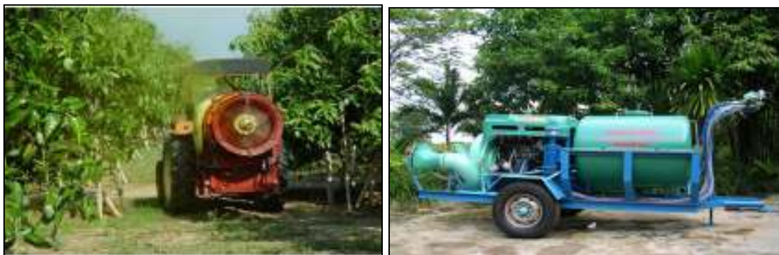
ภาพที่ 14 เครื่องยนต์พ่นสารแบบใช้แรงลมขนาดใหญ่ เครื่องยนต์พ่นสารแบบแอร์บลัสท์ (ซ้าย) และแบบแอร์เซียร์ (ขวา)
