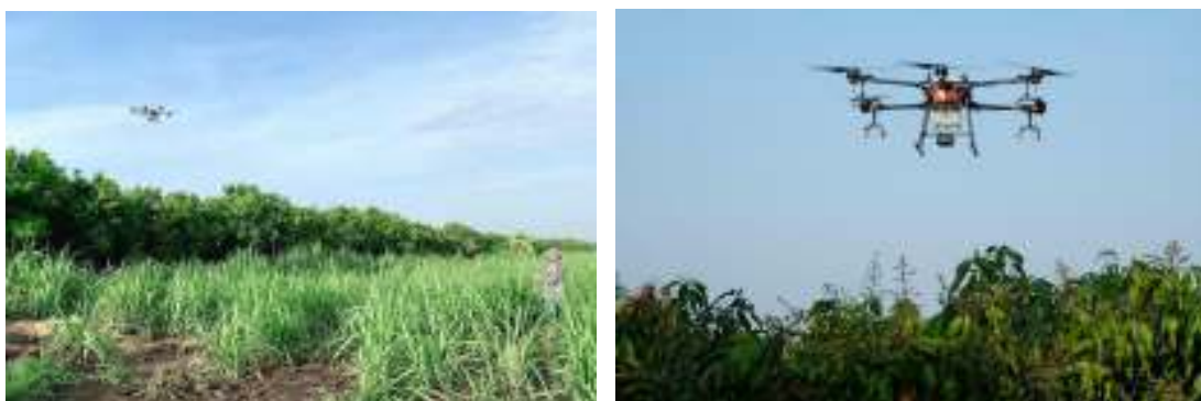
ภาพที่ 3 การพ่นสารด้วยอากาศยานไร้คนขับในการป้องกันกำจัดเพลี้ยไฟในมะม่วง
