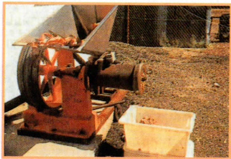
▶ เครื่องโม่ปลาหรือเครื่องบดเนื้อ ใช้สำหรับบดวัตถุดิบแบบเปียก
