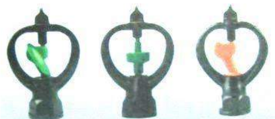
ภาพที่ 5.23 หัวมินิสปริงเกอร์ขนาดใหญ่ อัตราจ่ายน้ำ 600-1,000 ลิตร/ชั่วโมง
