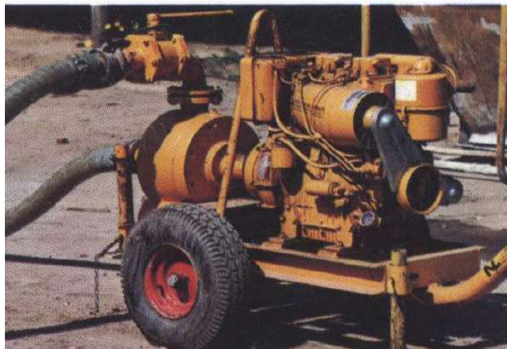
ภาพที่ 10.13 เครื่องสูบน้ำใช้เครื่องยนต์เป็นต้นกำลัง
