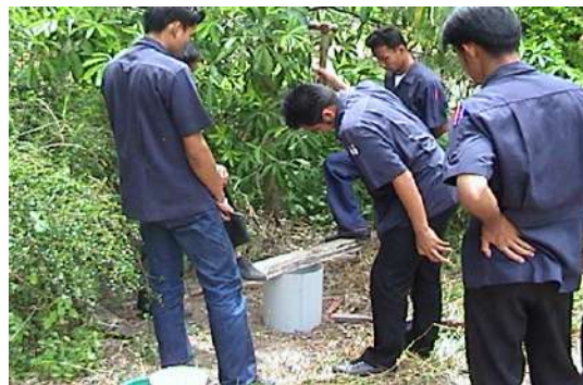
ภาพที่ 3.16 ถังวัดอัตราการซึมของน้ำ (Cylinder Infiltrrometer)
