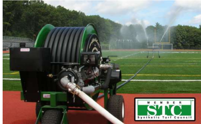
ภาพที่ 7.14 ท่อประธานชนิดเคลื่อนย้ายได้ใช้ท่อพีอี (ที่มา : agriculture.indiabizclub.com , ม.ป.ป.)
