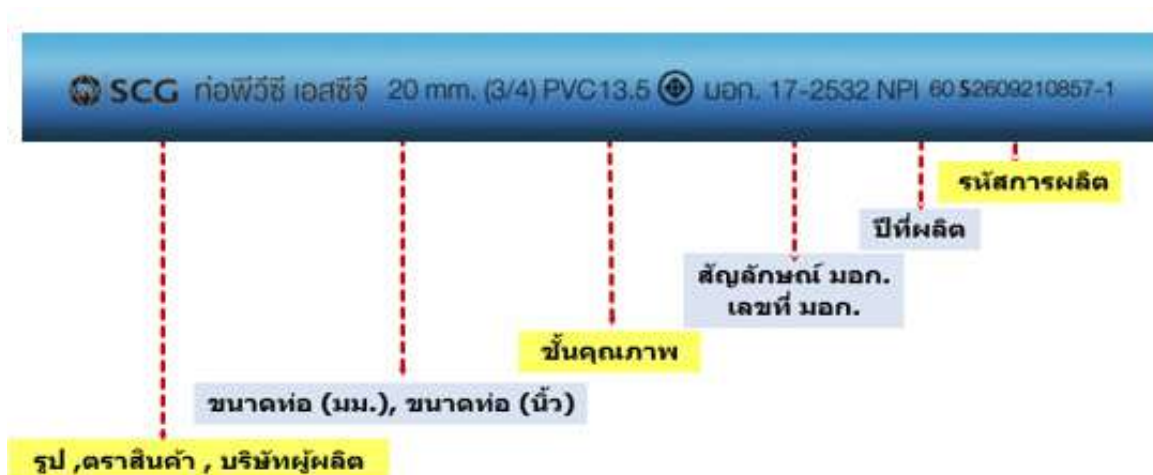
ภาพที่ 8.12 ขนาดระบุของท่อบอกรายละเอียดบนเส้นท่อ (ที่มา : ท่อเอสซีจี)
