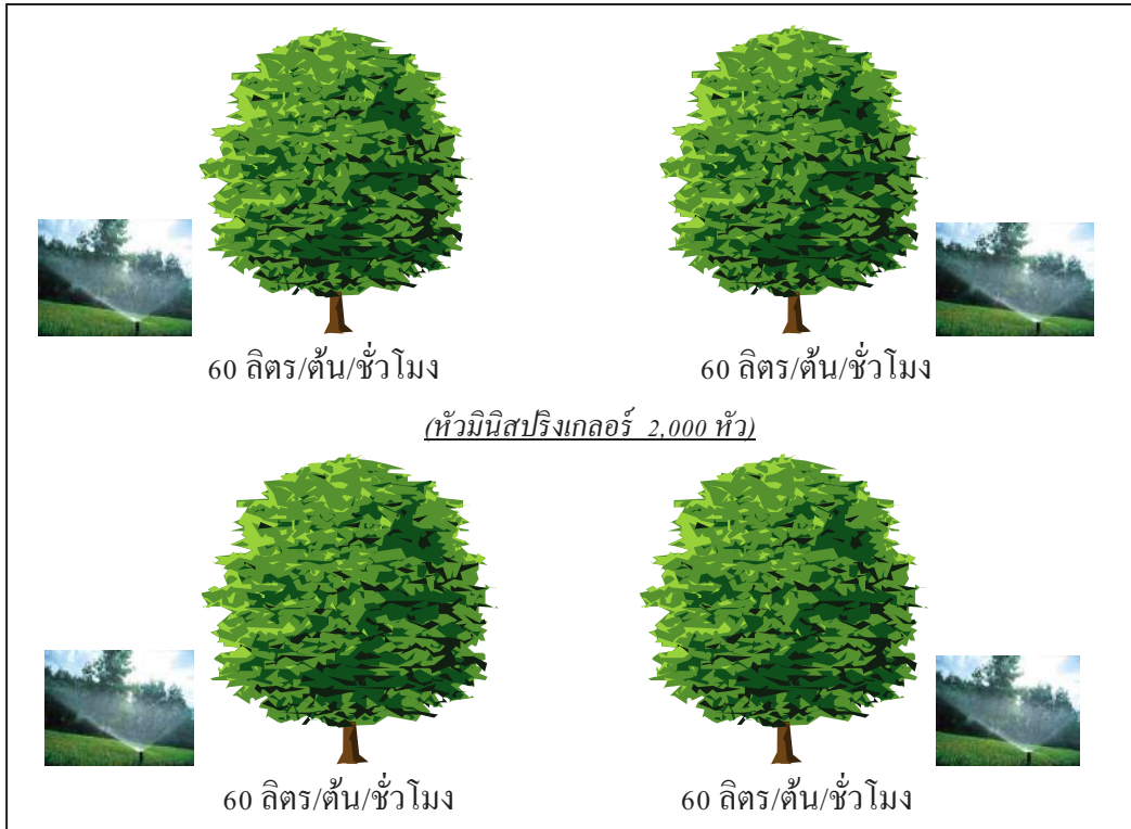
ภาพที่ 10.2 ทางเลือกที่ 1 เลือกให้น้ำครั้งเดียวพร้อมกัน 20 ไร่ ใช้เวลาในการให้น้ำ 1 ชั่วโมง (ที่มา : ศูนย์ฝึกอบรมวิศวกรรมเกษตร, ม.ป.ป.)
