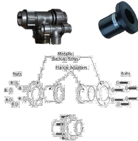
ภาพที่ 8.11 การเชื่อมต่อท่อพีอีโดยใช้ข้อต่อสวมรัด
