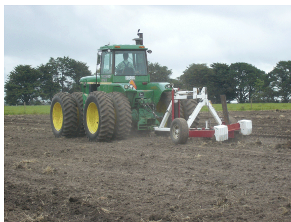
ภาพที่ 9.5 ภาพการลากไถระบายน้ำ (Mole Drain) ในแปลงเพาะปลูก (ที่มา : tgdrains.com.au)
