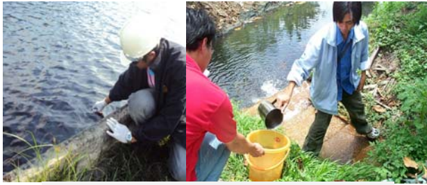
6. อุปกรณ์เก็บตัวอย่างน้ำ อาจใช้ขวดเก็บโดยตรงหรือใช้ถังเก็บแทนได้
