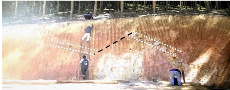
ภาพที่ 3 ลักษณะหน้าตัดดินที่มาสายควอดต์ผุ (เส้นไขปลาสีขาว) และรอยเลื่อนตัดผ่าน (เส้นประสีดำ) เข้ามาในเนื้อหินมัสโควิต-ไบโอไทต์ผุอยู่ ในพื้นที่แหล่ง “เขาทรายแดง”
