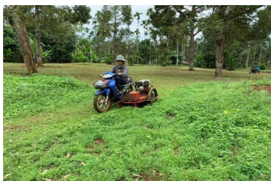
เครื่องตัดหญ้านำมาติดกับมอเตอร์ไซด์แบบรถพ่วงเพื่อลดต้นทุนแรงงานการตัดหญ้า
