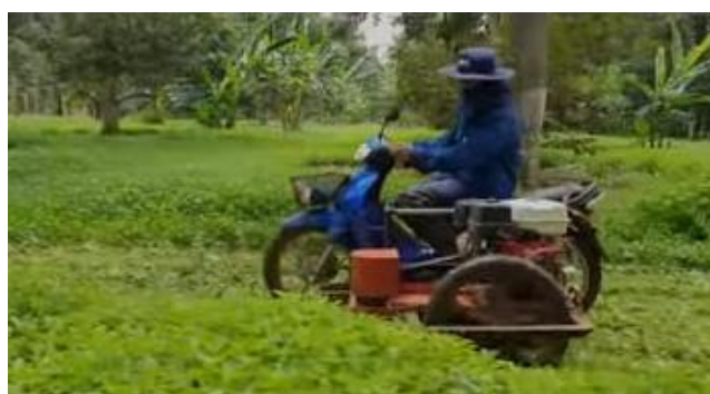
เครื่องตัดหญ้านำมาติดกับมอเตอร์ไซด์แบบรถพ่วงเพื่อลดต้นทุนแรงงานการตัดหญ้า
