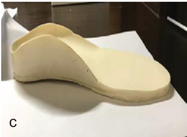
ภาพที่ 4 ลักษณะแผ่นรองเท้าสำเร็จรูป (Prefabricated Insole) ที่ผลิตจากน้ำยางธรรมชาติเมื่อมองจากด้านบน (a) ด้านหลัง (b) และด้านข้าง (c และ d)
