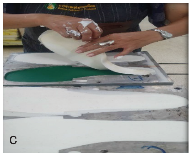
ภาพที่ 3 ขั้นตอนการผลิตแผ่นรองเท้า (a) ทำความสะอาดเบ้าพิมพ์และฉีดสารกันติดให้ทั่วเบ้าพิมพ์ (b) เทส่วนผสมน้ำยางหลังปั่นให้เกิดฟองลงในเบ้าพิมพ์แล้วทิ้งให้เซตตัว (c) เมื่อยางคงรูปแล้ว เอาแผ่นรองเท้าไปออกจากเบ้าพิมพ์
