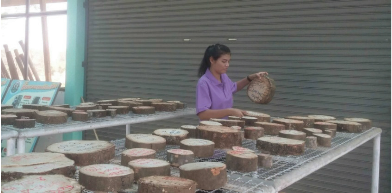
ภาพที่ 4 วัดเส้นรอบวงของเซียงแต่ละระดับ และบันทึกรายละเอียดต่างๆ ในด้านล่าง (ด้านที่อยู่ส่วนราก)
