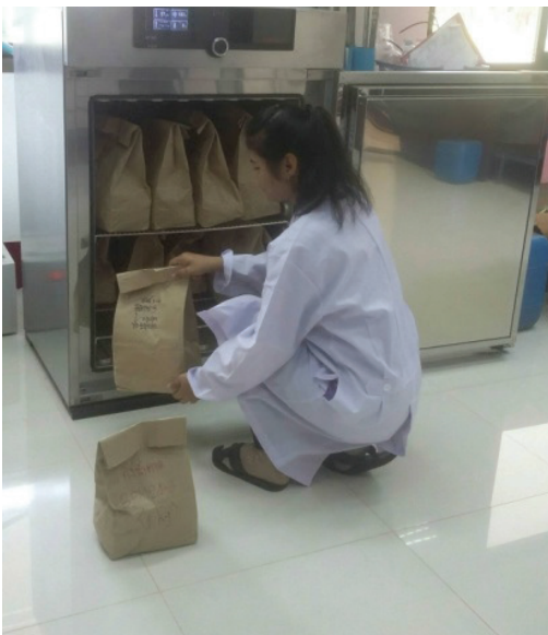
ภาพที่ 5 อบแห้งตัวอย่างด้วยตู้อบลมร้อน (Hot air oven) ที่อุณหภูมิ 80 องศาเซลเซียส เป็นเวลาต่อเนื่อง 5 วัน หรือจนน้ำหนักแห้งคงที่ และบันทึกน้ำหนักแห้งของเซียงแต่ละระดับ
