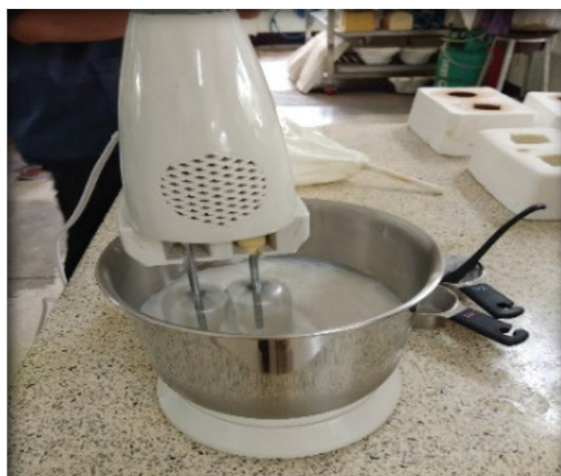
ภาพที่ 1 อุปกรณ์สำหรับปั่นน้ำยางให้เกิดฟอง ประกอบด้วยหม้อปั่นใช้บรรจุน้ำยาง และอุปกรณ์ปั่นลักษณะคล้ายลูกตะกร้อ ทำด้วยโลหะ หมุนได้รอบตัวเอง และรอบหม้อปั่น
