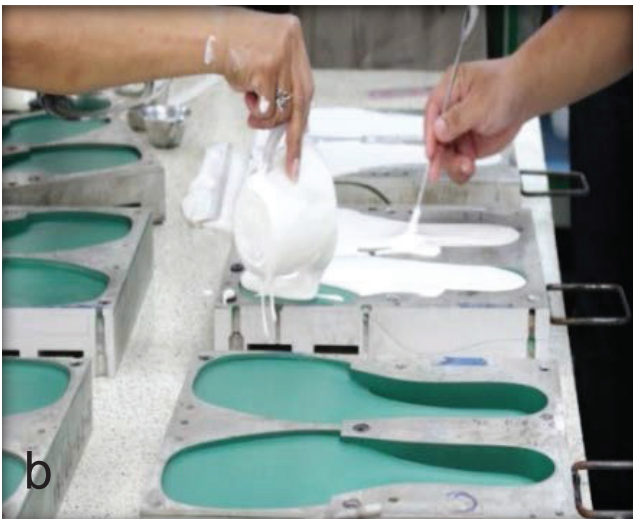
ภาพที่ 3 ขั้นตอนการผลิตแผ่นรองเท้า (a) ทำความสะอาดเบ้าพิมพ์และฉีดสารกันติดให้ทั่วเบ้าพิมพ์ (b) เทส่วนผสมน้ำยางหลังปั่นให้เกิดฟองลงในเบ้าพิมพ์แล้วทิ้งให้เซตตัว (c) เมื่อยางคงรูปแล้ว เอาแผ่นรองเท้าไปออกจากเบ้าพิมพ์
