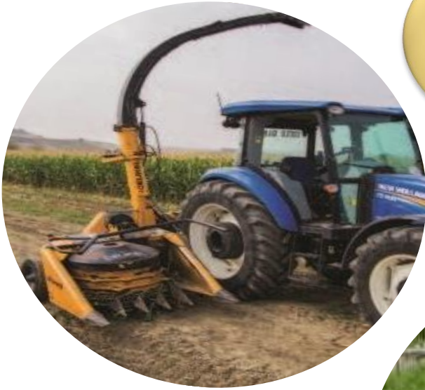
เครื่องตัดพืชอาหารสัตว์แบบดับเบิลชอป (Double chop) หน้ากว้าง 1.25 เมตร 750,000 บาท
